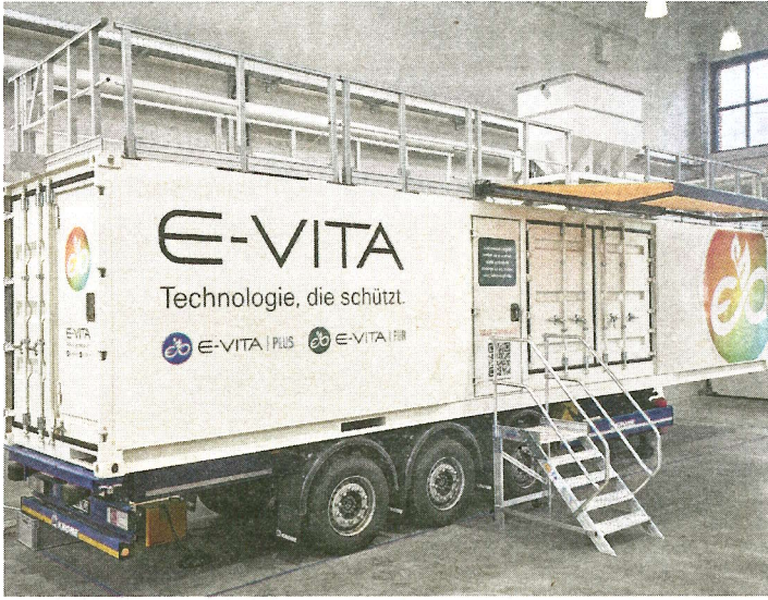
Bei dem E-Vita-Verfahren durchläuft das Saatgetreide einen Elektronenschleier, der fast alle Krankheitserreger abtötet, leider nicht den Gerstenflugbrand. Die Anlage ist mobil.
